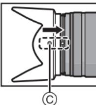
2 Gire la visera de la lente en la dirección de la flecha hasta que se detenga y alinee la marca de tope D en el lado largo de la visera de la lente con la marca en la punta de la lente.
