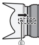
**2 Gire la visera de la lente en la dirección de la flecha hasta que se detenga y alinee la marca de tope ⑥ en el lado largo de la visera de la lente con la marca en la punta de la lente.**
