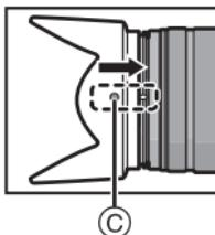
**2 Gire la visera de la lente en la dirección de la flecha hasta que haga clic y luego alinee la marca de tope del pétalo más largo de la visera de la lente con la marca del extremo de la lente.**
