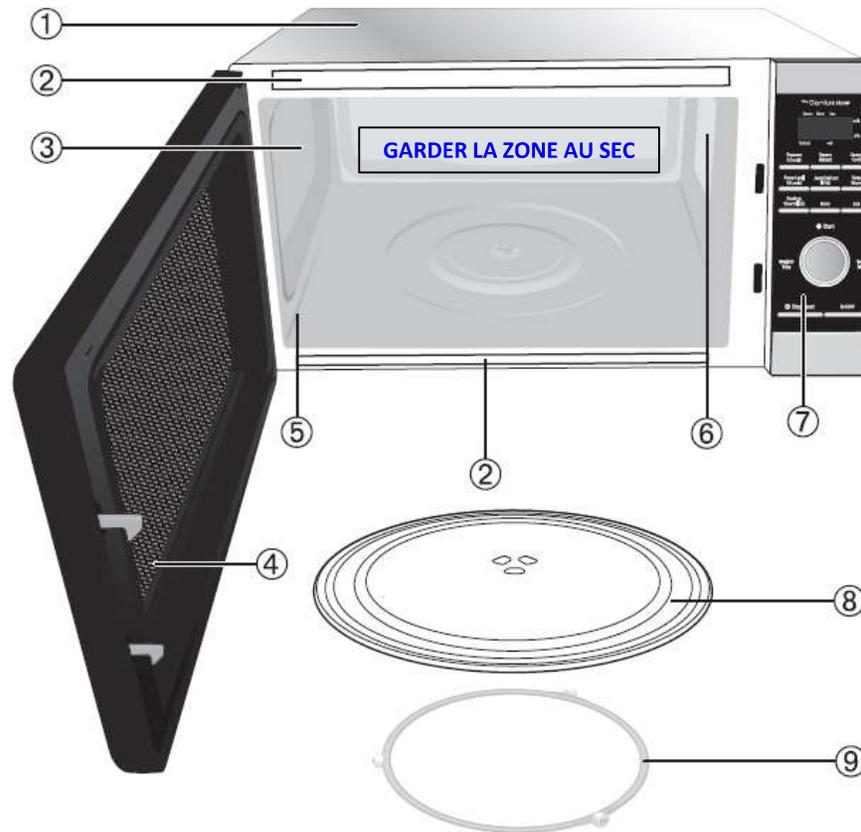
**5. Sole de la cavité du four:** Nettoyer la sole du four avec un chiffon humecté de détergent doux ou de nettoyant à verre, puis essuyer.
