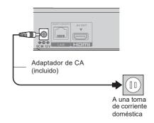
Conexión a un televisor compatible con HDMI y a un amplificador/receptor compatible con HDMI
