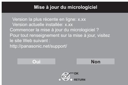
NE PAS DÉBRANCHER l'appareil de sa source d'alimentation ou effectuer d'autres opérations pendant le processus de mise à jour du micrologiciel. Une fois le micrologiciel installé, le message "FINISH" apparaît sur l'afficheur de l'appareil. L'appareil se remet en marche et l'écran suivant est affiché.
